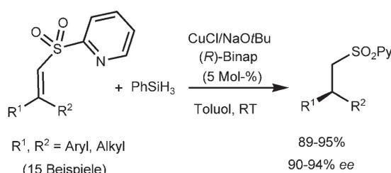
**Vielseitige Zwischenstufen:** Die asymmetrische konjugierte Reduktion von  $\beta,\beta$ -disubstituierten  $\alpha,\beta$ -ungesättigten 2-Pyridylsulfonen mit Silanen unter Cu<sup>I</sup>/Binap-Katalyse ergibt chirale Sulfone mit hervorragenden Ausbeuten und Enantio-
