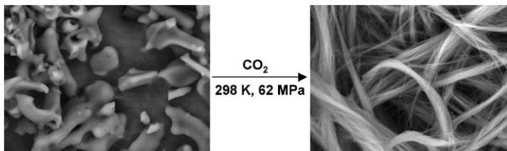
**Gleiches löst sich in Gleichem:** Diharnstoffe mit umweltverträglichen  $\text{CO}_2$ -philen Gruppen aus peracetylierten Gluconsäureeinheiten lösen sich in überkritischem  $\text{CO}_2$  bei 298 K und 62 MPa. Nach dem
