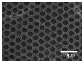
**Verhaltensmuster:** In CHCl<sub>3</sub> erzeugte Komplexe aus dem Cluster {Mo<sub>72</sub>Fe<sub>30</sub>} und dem Tensid Dioctadecyldimethylammoniumchlorid (DODMACl) bilden beim Verdampfen des Lösungsmittels Muster mit Wabenstruktur an der Luft-Wasser-Grenzfläche (siehe SEM-Bild). Die Tensidkonzentration entscheidet, ob die {Mo<sub>72</sub>Fe<sub>30</sub>}-Makroanionen in der wässrigen oder der CHCl<sub>3</sub>-Phase verbleiben.
